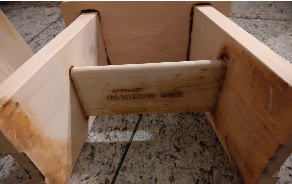
0003 当初からの使用塗料（油性防カビ・防腐・対候性） + セラミック塗料（初期撥水あり）
